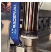
Drenaje de flujo de 1 1/4". Con paso completo.
