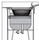
Sistema de drenaje 3/4" individual de aceite y de agua.
