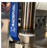
Drenaje de flujo de 1 1/4". Con paso completo.
