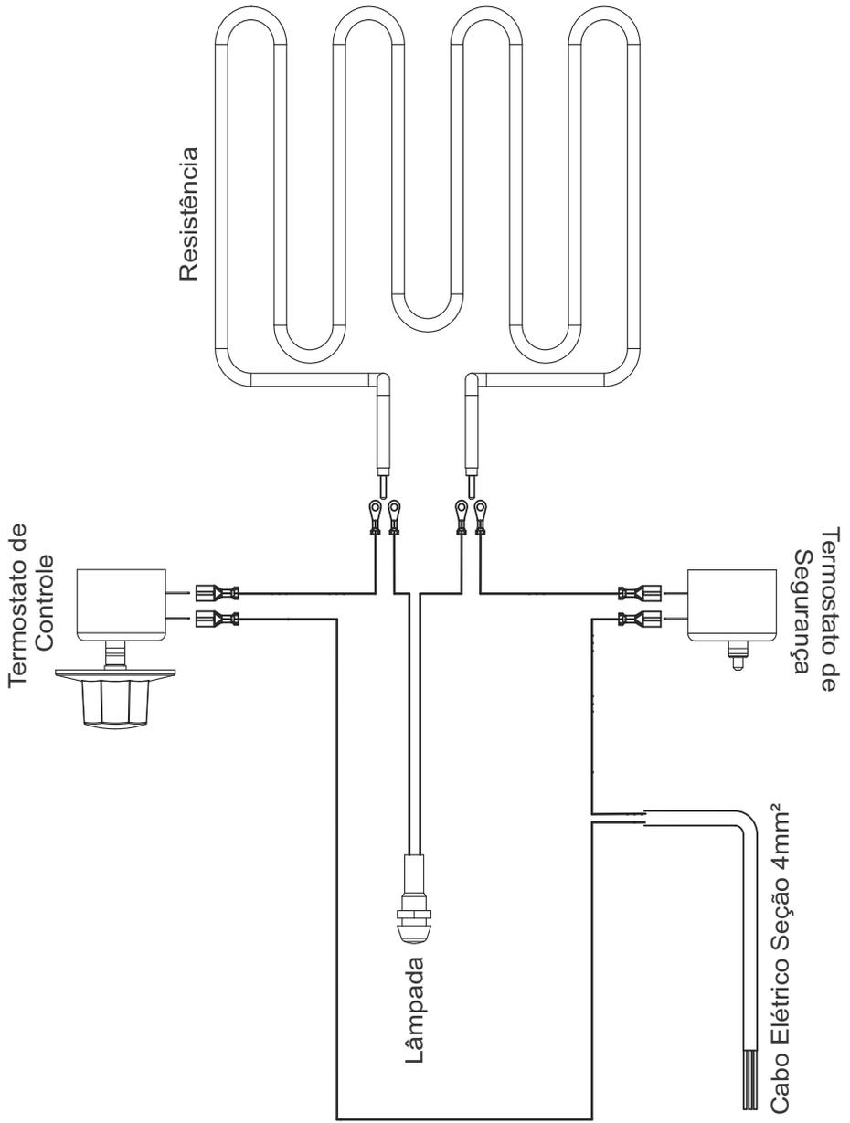
ESQUEMA ELÉTRICO FOE 15 800W
