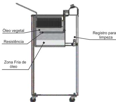
Durante a instalação: não coloque em superfícies ou perto de paredes, divisórias ou móveis de cozinha e similares, a menos que eles sejam feitos de material incombustível ou revestidos com material de isolamento térmico de incombustível e atenção as normas de prevenção de incêndio.
