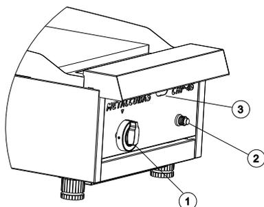
3 - As válvula industriais não tem definido os estágio de fogo alto e fogo baixo assim como as domesticas, portanto para utilizar o fogo baixo, vá girando lentamente o botão no sentido horário como se fosse desligar o queimador até o fogo ficar na altura desejada (utilize os furos frontais para visualizar o fogo)
