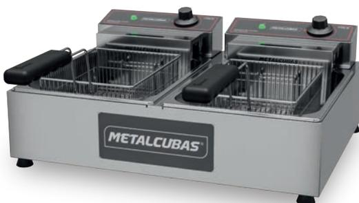
Fabricado externamente em aço inox escovado 430, cubas em aço inox com 150 mm de profundidade e tampa em aço inox. Painel removível com resistências blindadas em aço inox. Termostato para controle de temperatura, termostato de segurança e lâmpada piloto o que indica o funcionamento das resistências. Disponível em 127 e 220V.
