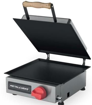
Base superior e base inferior em aço carbono SAE 1020 de 2,0 mm estampado. Prensa superior com aquecimento e isolamento térmico. Resistências em aço inoxidável, termostatos independentes para controle de temperatura, pés de borracha antiderrapantes com regulagem e estrutura em aço inox 430 escovado. Disponível em 127V e 220V.
