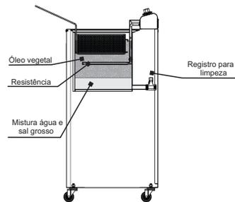
Durante a instalação: não coloque em superfícies ou perto de paredes, divisórias ou móveis de cozinha e similares, a menos que eles sejam feitos de material incombustível ou revestidos com material de isolamento térmico de incombustível e atenção as normas de prevenção de incêndio.
